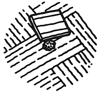
①補修用のクッションフロア材を焼きこげの上に重ねる。
